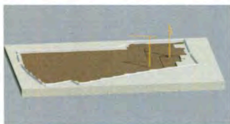
工况一：I 区 36#、37#、38# 号房及地库区域开挖至 -3.25m。
